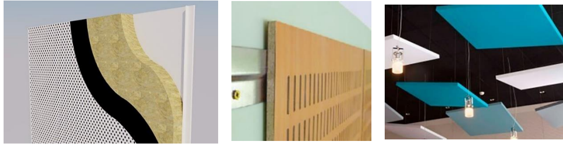
Figura 16. Ejemplos de soluciones de absorción acústica. En general se contempla un material absorbente (lana mineral por ejemplo) y luego un revestimiento de terminación perforado (placa metálica, yeso cartón, madera ranurada, etc.)
