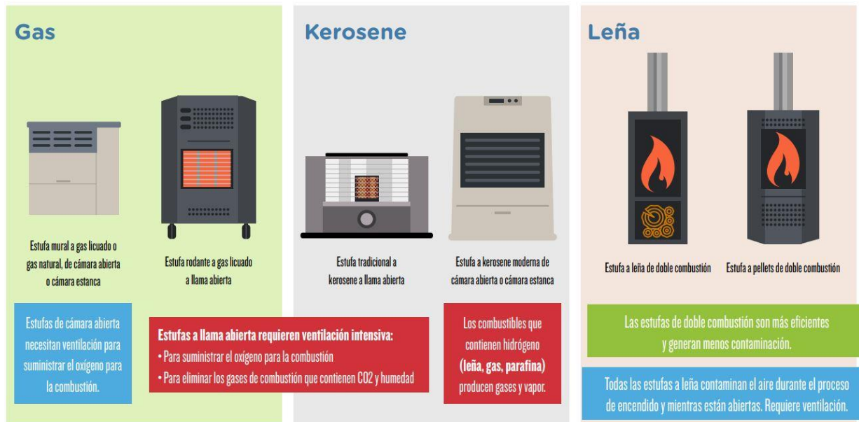
Figura 19. Ejemplos de sistemas de calefacción individual (estufas). Aquellas con llama abierta general alta contaminación interior. Las otras generan menos contaminación, pero requieren igualmente de ventilación, con las consecuentes pérdidas térmicas. Fuente: www.vivesustentable.cl .
